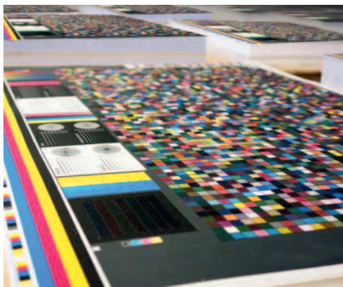
Druckbogenstapel mit Messchart-Abbildung für die Papierprofilierung.
